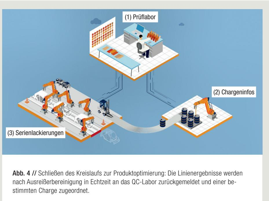
Abb. 4 // Schließen des Kreislaufs zur Produktoptimierung: Die Linienergebnisse werden nach Ausreißerbereinigung in Echtzeit an das QC-Labor zurückgemeldet und einer bestimmten Charge zugeordnet.
